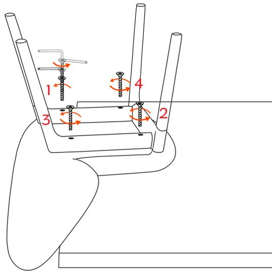
Posizionare la struttura della sedia capovolta sopra la seduta ed avvitare i due componenti con le viti fornite. | Put the chair wooden base on the shell layed previously upside-down and screw the two elements with the given screws.
