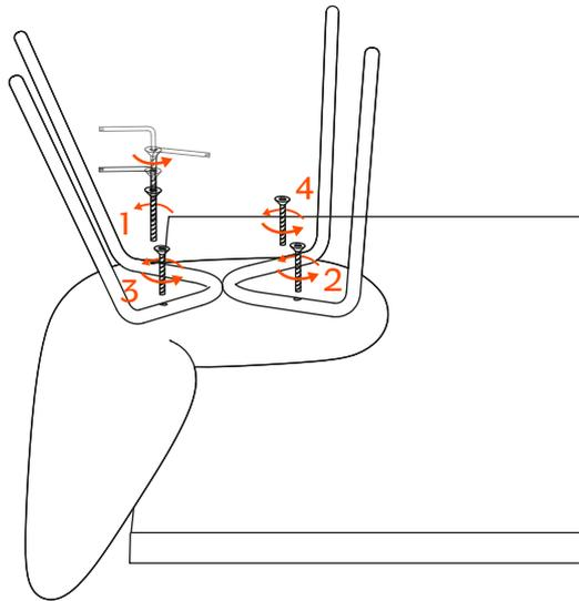
Posizionare la struttura della sedia capovolta sopra la seduta ed avvitare i due componenti con le viti fornite. | Put the chair metal base on the shell layed previously upside-down and screw the two elements with the given screws.
