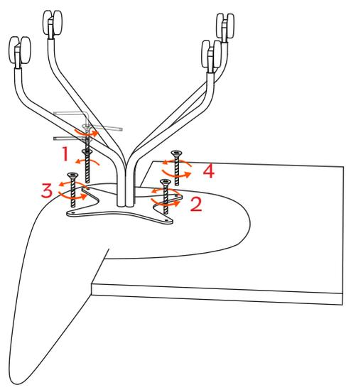
Posizionare la base con ruote capovolta sopra la seduta ed avvitare i due componenti con le viti fornite. | Put the chair swivel base on castors on the shell layed previously upside-down and screw the two elements with the given screws.
