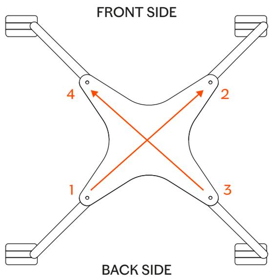
Avvitare la base seguendo l'ordine dei numeri illustrati, per garantire maggior precisione nel montaggio. | Screw the swivel base on castors, following the illustrated order, to ensure a higher precision.
