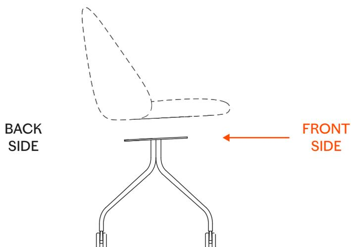
ATTENZIONE! La parte frontale della base su ruote è quella **più alta**, come da immagine. | WARNING! The front-side of the swivel 4-star base on castors is the **higher** one, as shown in the picture.
