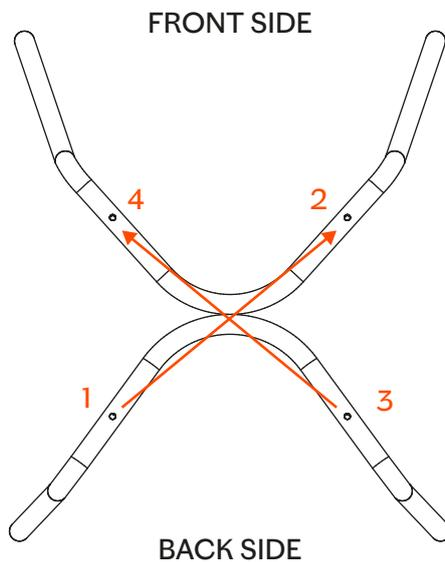
Avvitare la base seguendo l'ordine dei numeri illustrati, per garantire maggior precisione nel montaggio. | Screw the metal base, following the illustrated order, to ensure a higher precision.
