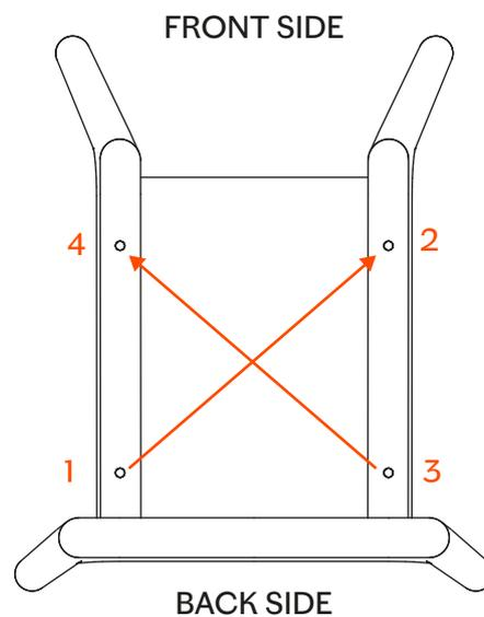
Avvitare la base seguendo l'ordine dei numeri illustrati, per garantire maggior precisione nel montaggio. | Screw the wooden base following the illustrated order, to ensure a higher precision.
